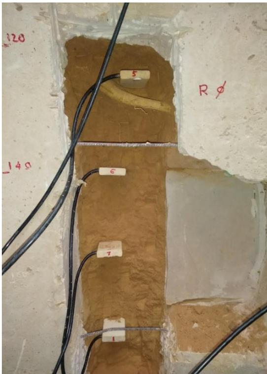
Photo 7: Sondes TDR. Les sondes TDR sont insérées dans le puits 2 à différentes profondeurs.
