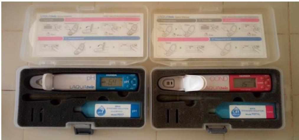
Figure4 : pH-mètre (bleu) et conductimètre (rouge) utilisés
